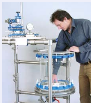
Swing-out mechanism for removal of filter cake Ausschwenkmechanismus zur Entnahme des Filterkuchens
