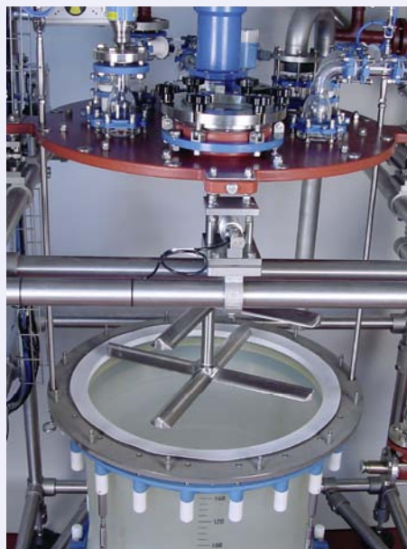
150 l solidphase reactor with filter, stirrer and load cells Solidphase-Reaktor mit Filter, Rührer und Wägezellen
